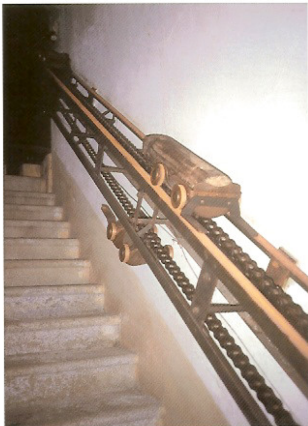
Meccanismo per trasportare i proiettili nella batteria corazzata.
